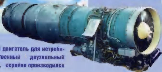
**R11-300** - турбореактивный двигатель для истребителя МиГ-21, первый отечественный  $\Delta$  двухвальный ТРД, взлетная тяга 5000 кг, серийно производился с 1958 года.
